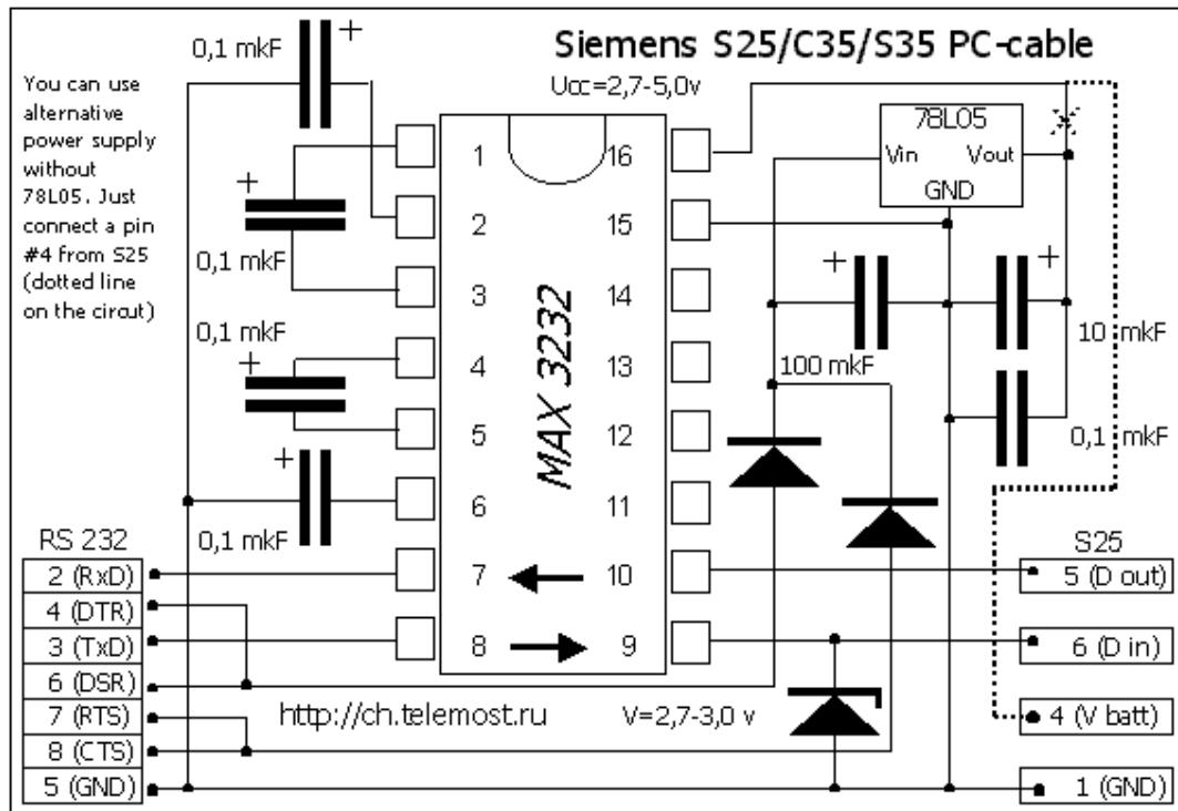
Также во многих схемах сильно различаются номиналы конденсаторов типового включения ИС - от 0,1 до 10 мкф. Я так и не понял, чем это вызвано, ведь в фирменной спецификации четко обозначено - все емкости по 0,1 мкф. Могу только предположить, что возможно применение других номиналов, главное, чтобы они были одинаковы.
